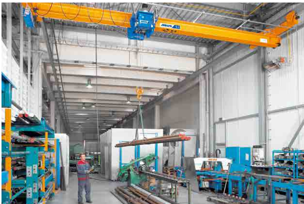
Polipasto monor- rail del modelo E en un puente grúa suspendido EDL
