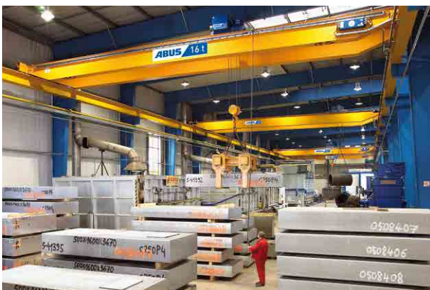
Polipastos birrailes del modelo D en puentes grúa birrailes.
