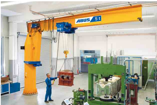
Polipasto monor- rail del modelo E en una grúa pluma de columna VS
